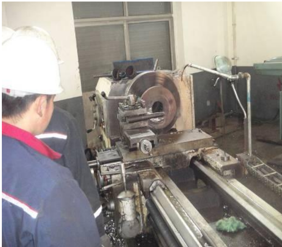
在通用设备教学生产车间车芯棒教学生产加工
