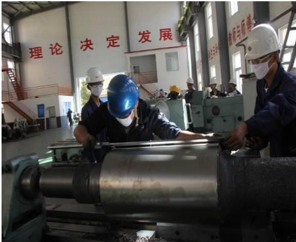
企业技术人员魏长利指导学生轧辊的刀具装夹
