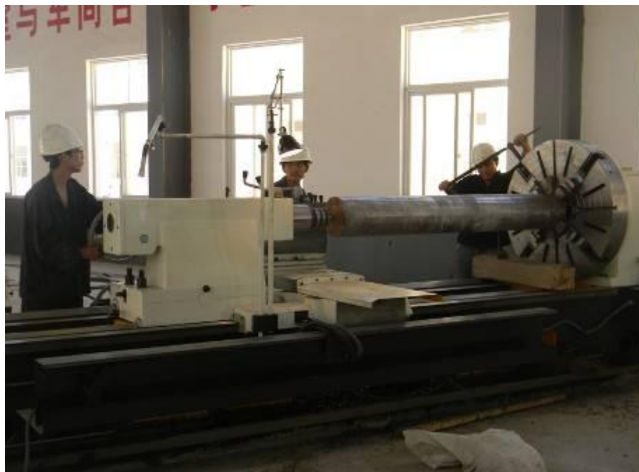
在通用设备教学生产车间车芯棒教学生产加工
