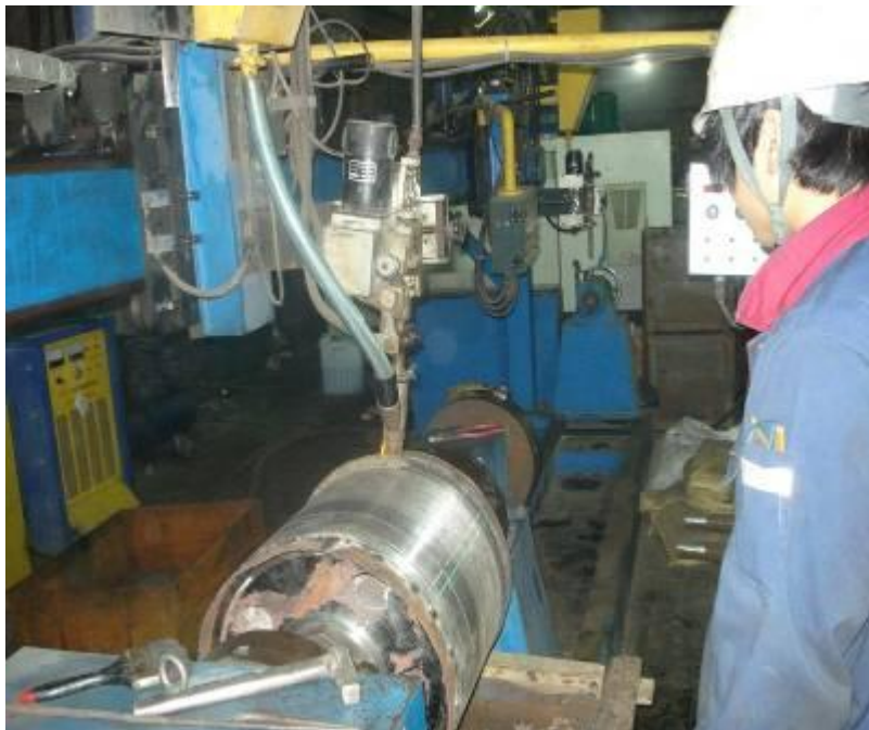
学生在大方堆焊车间补焊轧辊
